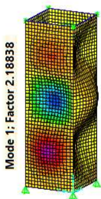
Obr. 4 Kritický tvar a násobok kritického zaťaženie
